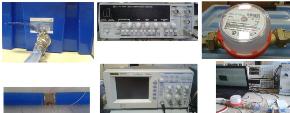
Рис. 8. Фрагменты экспериментальной установки для исследования датчика расхода
