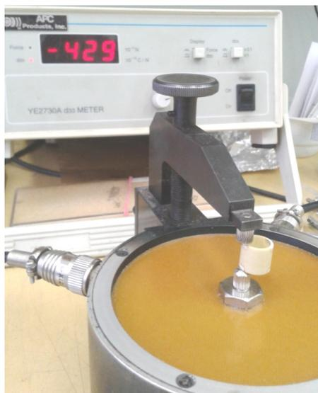
Рис. 7. Измерение пьезомодуля
